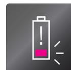
**Batterietiefstandsalarm bei 10 V und Abschaltung bei 9,5 V**
