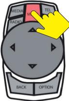
Mantenga presionada la tecla MENÚ para cambiar entre el sistema OEM y el sistema ANDROID.
