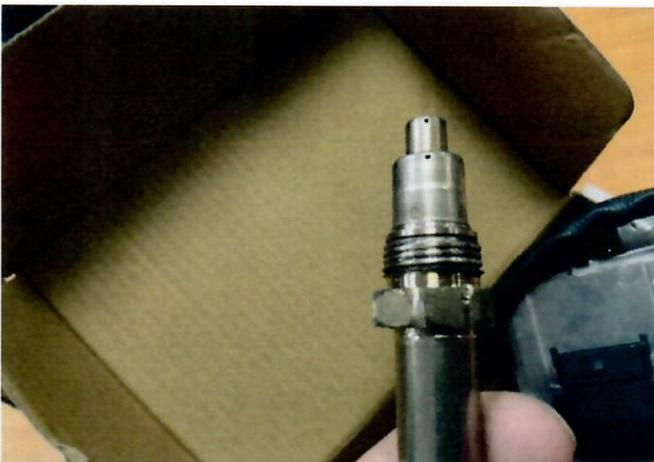
**Abb. 11.** Beschädigter Sensor an Gewinde und Schraubkopf
