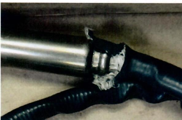
**Abb. 14.** Hinweis auf beschädigte Kabel
