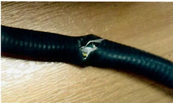
**Abb. 13.** Beschädigter Kabelschutz
