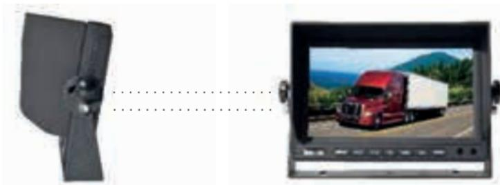
3. Placez le moniteur à l'emplacement de montage souhaité, puis serrez les vis situées au bas du support (voir les illustrations ci-dessous).
